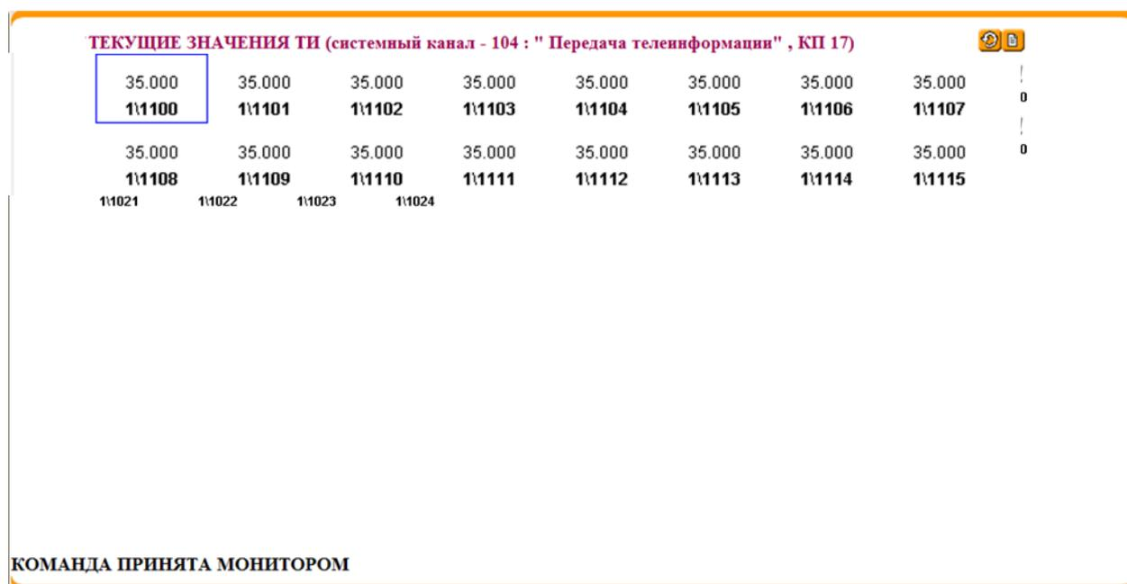
Рисунок 18 – Окно «Текущие значения ТИ» (вид после нажатия на командную кнопку «Запросить текущие значения»)
